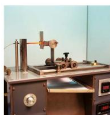
Essai au fil incandescent à 960°C s/EN 61537.
