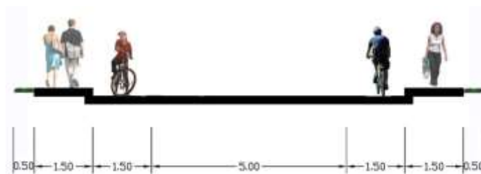
Voie primaire - 12 m d'emprise bande plantée ou extension du trottoir pour recevoir le mobilier urbain
